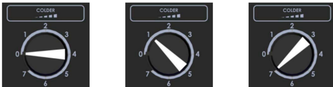
Schéma 1. Réglage du thermostat de la tireuse
