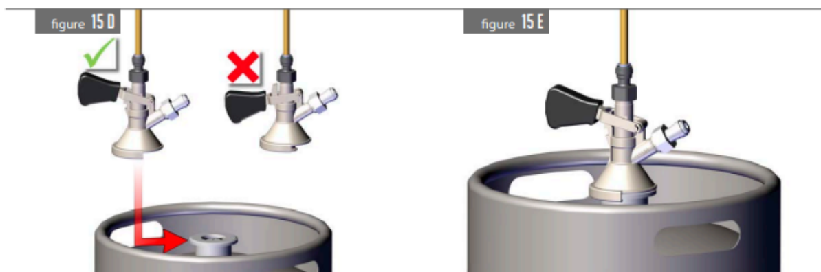
Schéma 4. Insertion de la tête de tirage sur la tête de fût
